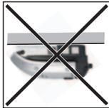
Den Wechselrichter nicht an der Decke montieren.
