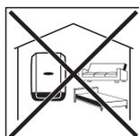
Auf Grund von leichter Geräuschentwicklung in bestimmten Betriebszuständen den Wechselrichter nicht im unmittelbaren Wohnbereich montieren.
