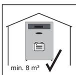
Die Batterie ist nur für die Montage im Innenbereich geeignet. Um das Auftreten eines explosionskritischen Gemisches im Fehlerfall zu verhindern, muss die Batterie in einem Raum mit mindestens 8 m<sup>3</sup> Raumvolumen aufgestellt werden.
